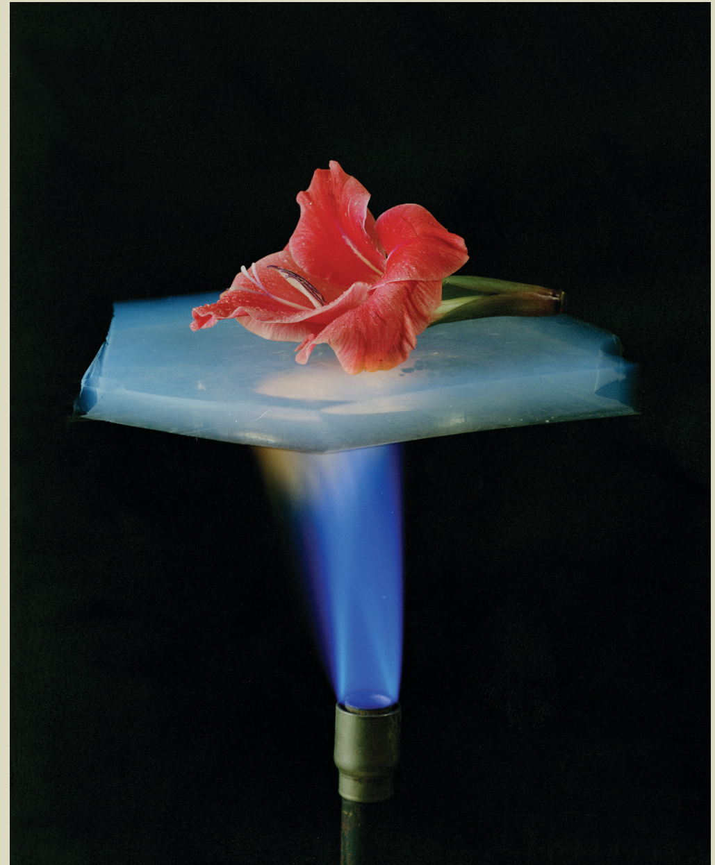
Abb. 2: Bunsenbrennerflamme, ca. 1200^\circ \text{ Celsius} , Aerogelplatte mit Blume, Brenndauer 10 Minuten
